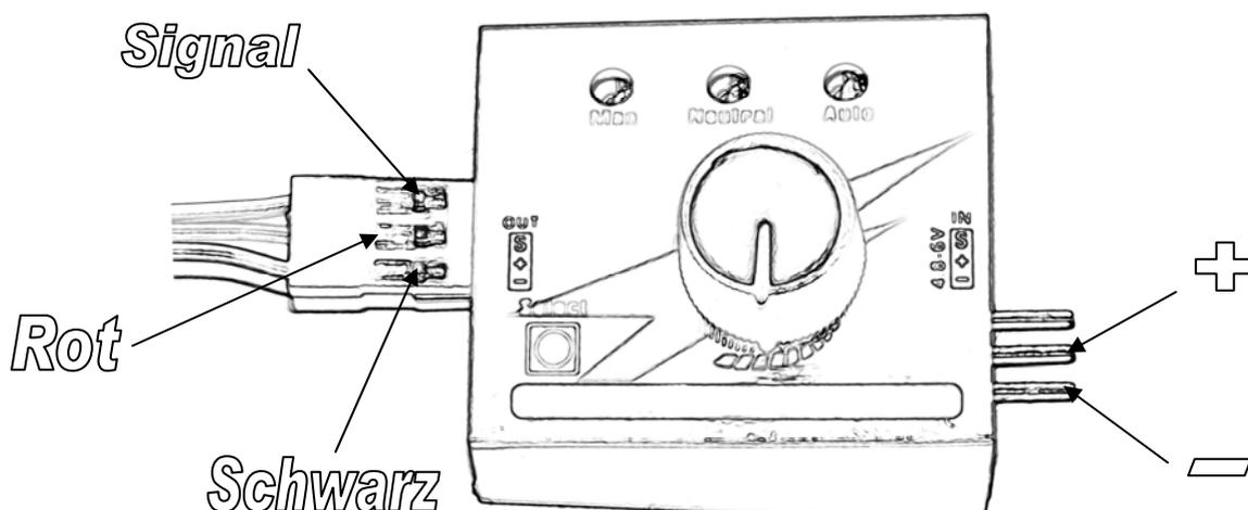
Der mitgelieferte ELKO ist auf der +/- Seite (Stromversorgung) anzubringen. Bei den Servos MINI und MICRO ist der passende Stecker bereits vorhanden. Bei den NANO Servo ist die Anschlußbelegung
